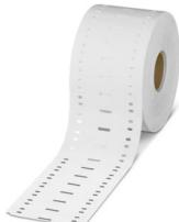
Marcador de cables, Rollo, blanco, sin rotular, rotulable con: THERMOMARK E.300 (D)/600 (D), THERMOMARK ROLL 2.0, THERMOMARK ROLL, THERMOMARK ROLL X1, THERMOMARK ROLLMASTER 300/600, THERMOMARK X1.2, clase de montaje: Montaje con sujetacables, diámetro de cable:  $\geq 6$  mm, Número de índices individuales: 1000, altura del campo de texto: 15 mm, anchura del campo de texto: 55 mm
