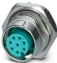
Conect. enchuf. para apar. pared poster., 8-polos, Hembra de conexión, recto, M12-SPEEDCON, codificación: A, Montaje en pared trasera, M16 x 1,5, Patillas de soldar, Producto alternativo según RoHS II sin excepción 6c (Pb < 0,1 %) código de art.: 1239819
