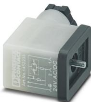
Conector de válvula, Universal, 3-polos, Conector de válvula B (10 mm), Conexión por tornillo, prensaestopas M16, diámetro exterior del cable 6 mm ... 8 mm
