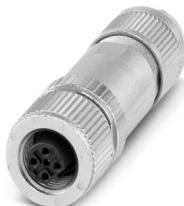
Conector, Universal, 5-polos, apantallado, Hembra de conexión recto M12, codificación: B, Conexión por resorte push lock, material de moleteado: Fundición inyectada de cinc, niquelada, diámetro exterior del cable 4 mm ... 8 mm
