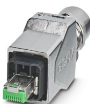
Conector enchufable RJ45, índice de protección: IP65/IP67, número de polos: 8, 1 GBit/s, CAT5, material: Metal, tipo de conexión: Conexión rápida IDC, sección de conexión: AWG 23- 22, salida de cables: recta, Ethernet
