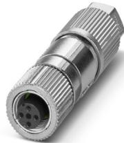
Conectores para datos, PROFINET CAT5 (100 MBit/s), 4-polos, sin halógenos, apantallado, Hembra de conexión recto M12, codificación: D, Conexión por desplaz. de aislamiento, material de moleteado: Fundición inyectada de cinc, niquelada, diámetro exterior del cable 5 mm ... 9,7 mm
