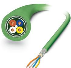
Cable de datos, PROFINET CAT5 (100 MBit/s), 4-polos, PVC/PVC, verde RAL 6018, apantallado, extremo de cable libre, a extremo de cable libre, longitud de cable: 100 m
