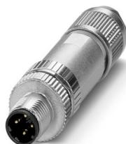
Conector, PROFINET CAT5 (100 MBit/s), 4-polos, apantallado, Conector macho recto M12, codificación: D, Conexión por resorte push lock, material de moleteado: Fundición inyectada de cinc, niquelada, diámetro exterior del cable 4 mm ... 8 mm
