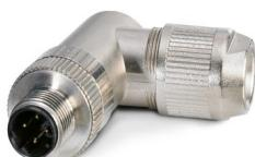
Conectores para datos, PROFINET CAT5 (100 MBit/s), 4-polos, apantallado, Conector macho acodado M12, codificación: D, Conexión por desplaz. de aislamiento, material de moleteado: Latón, niquelado, diámetro exterior del cable 4 mm ... 8 mm
