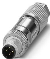
Conectores para datos, PROFINET CAT5 (100 MBit/s), 4-polos, sin halógenos, apantallado, Conector macho recto M12, codificación: D, Conexión por desplaz. de aislamiento, material de moleteado: Fundición inyectada de cinc, niquelada, diámetro exterior del cable 5 mm ... 9,7 mm
