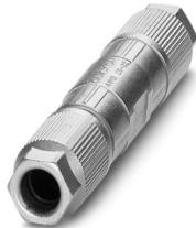
Empalmador de cables, PROFINET CAT5 (100 MBit/s), 4 polos, sin halógenos, apantallado, conexión con borne de conexión por corte de aislamiento, material de la carcasa: fundición inyectada de cinc, niquelado, diámetro exterior del cable 5 mm ... 9,7 mm
