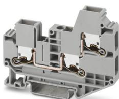
Borne de paso, tensión nominal: 1000 V, corriente nominal: 41 A, número de conexiones: 3, número de polos: 1, tipo de conexión: Conexión Push-X, Sección de dimensionamiento: 6 mm<sup>2</sup>, sección: 0,5 mm<sup>2</sup> - 10 mm<sup>2</sup>, clase de montaje: NS 35/7,5, NS 35/15, color: gris
