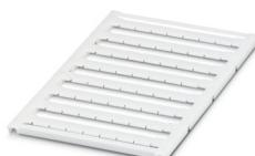
Marcador para bornes, Estera, blanco, sin rotular, rotulable con: BLUEMARK ID COLOR, BLUEMARK ID, BLUEMARK CLED, PLOTMARK, CMS-P1-PLOTTER, clase de montaje: enclavar, para ancho de borne: 8,2 mm, Número de índices individuales: 56, altura del campo de texto: 5,1 mm, anchura del campo de texto: 7,6 mm
