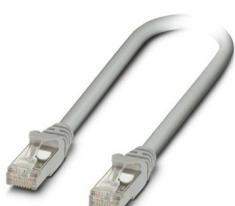
Cable patch, índice de protección: IP20, longitud de cable: 5 m, número de polos: 8, CAT5, tipo de conexión: Conexión Pierce, sección de conexión: AWG 26- 26, salida de cables: recta, Ethernet
