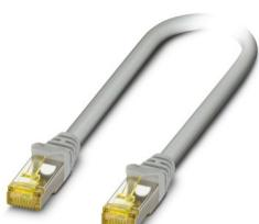
Cable patch, índice de protección: IP20, longitud de cable: 1,5 m, número de polos: 8, 10 GBit/s, CAT6<sub>A</sub>, tipo de conexión: Conexión Pierce, sección de conexión: AWG 26- 26, salida de cables: recta, Ethernet
