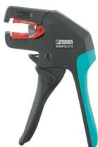
Pelacables para líneas y conductores de 4 - 16 mm<sup>2</sup>, autoajustable, longitud de pelado hasta 18 mm, capacidad de corte hasta 10 mm<sup>2</sup> flexible /1,5 mm<sup>2</sup> rígido, cuchilla de desaislar sustituible
