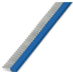
Punteras de cinta,  $0,75 \text{ mm}^2$ , longitud del manguito 8 mm, con cuello de plástico, según DIN 46228-4, color especial azul según NF C63-023, equipadas con extremo funcional para un mecanizado seguro y cómodo con Crimphandy, 20 tiras con 50 manguitos por tira.
