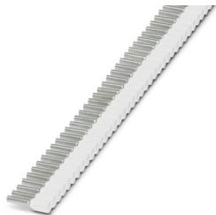
Punteras de cinta,  $0,75 \text{ mm}^2$ , longitud del manguito 8 mm, con cuello de plástico, según DIN 46228-4, color especial blanco, equipadas con extremo funcional para un mecanizado seguro y cómodo con Crimphandy, 20 tiras con 50 manguitos por tira.
