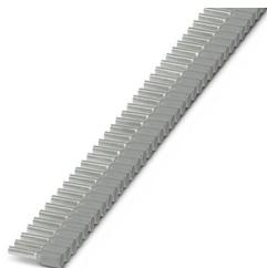
Punteras de cinta, 0,75 mm<sup>2</sup>, longitud del casquillo 8 mm, con cuello de plástico, según DIN 46228-4, color gris, equipado con extremo funcional para un mecanizado seguro y cómodo con Crimphandy, 20 tiras con 50 casquillos por tira.
