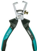
Tenazas pelacables, para desaislar cables de hasta 5 mm, para pelar conductores de hasta 10 mm<sup>2</sup>, escala para medir la longitud de pelado, con homologación VDE.
