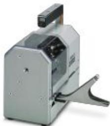
Engarzador y pelacables automático, construcción de 230 V, para punteras aisladas como material en cinta de 0,25 ... 2,5 mm<sup>2</sup>, longitud de manguito 8 mm, incl. juegos de reequipamiento de 0,5 ... 2,5 mm<sup>2</sup>
