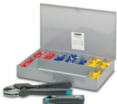
Caja de surtido de metal, equipada con punteras según DIN 46228-4, 300 udes. AI 10-12 RD, 200 udes. AI 16-12 BU, 100 udes. AI 25-16 YE, así como cuchilla de pelado WIREFOX-D 40 y pelacables CRIMPFOX 25R
