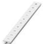
Tira Zack, Tiras, blanco, rotulado, rotulable con: CMS-P1-PLOTTER, rotulación longitudinal: números correlativos de 1 ...10, 11 ...20 etc. hasta 91 ...100, clase de montaje: encajar en ranura para índice alta, para ancho de borne: 10,2 mm, superficie útil: 10,15 x 10,5 mm, Número de índices individuales: 10
