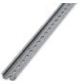
Carril simétrico perforado, Perfil estándar, anchura: 35 mm, altura: 7,5 mm, según EN 60715, material: Acero, Galvanizado, pasivado blanco, longitud: 2000 mm, color: plateado
