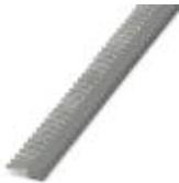
Punteras en cinta, 0,75 mm<sup>2</sup>, longitud del manguito 8 mm, con collar de plástico, según DIN 46228-4, gris, para el procesamiento con el CRIMPFOX 4 IN 1, 10 tiras con 50 manguitos por tira.
