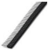
Punteras en cinta, 1,5 mm<sup>2</sup>, longitud del manguito 8 mm, con collar de plástico, según DIN 46228-4, negro, para el procesamiento con el CRIMPFOX 4 IN 1, 10 tiras con 50 manguitos por tira.
