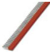
Punteras en cinta, 1,0 mm<sup>2</sup>, longitud del manguito 8 mm, con collar de plástico, según DIN 46228-4, rojo, para el procesamiento con el CRIMPFOX 4 IN 1, 10 tiras con 50 manguitos por tira.
