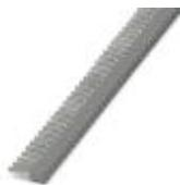
Punteras en cinta, 0,75 mm<sup>2</sup>, longitud del manguito 8 mm, con collar de plástico, según DIN 46228-4, gris, para el procesamiento con el CRIMPFOX 4 IN 1, 10 tiras con 50 manguitos por tira.
