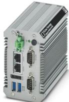
Ordenador PLCnext Industrial Edge con procesador N3350 Intel® Celeron®. Este dispositivo Edge programable con factor de forma reducido es compatible con IEC 61131-3, MATLAB Simulink, C/C++ y está perfectamente adaptado a la conversión de protocolos, captación de datos y Cloud Computing.
