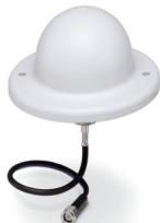
Antena omnidireccional con protección contra vandalismo para montaje en armario de control, banda de frecuencia: 2,4 GHz, ganancia: 3 dBi, índice de protección: IP55, resistente a los impactos: IK08, conexión: RSMA (macho), incl. cable de conexión de 1,5 m
