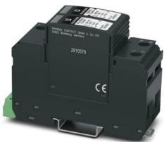
Descargador de sobretensiones enchufable según el tipo 2/clase II, para redes de alimentación de corriente monofásicas con N y PE separados (sistema de 3 conductores: L1, N, PE), con contacto de indicación remota.
