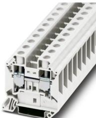
Borne de paso, tensión nominal: 1000 V, corriente nominal: 76 A, número de conexiones: 2, tipo de conexión: Conexión por tornillo, Sección de dimensionamiento: 16 mm<sup>2</sup>, sección: 1,5 mm<sup>2</sup> - 25 mm<sup>2</sup>, clase de montaje: NS 35/7,5, NS 35/15, color: blanco
