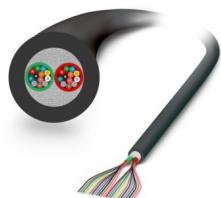
Canal universal GOF, 24 conductores, cable de hilos agrupados para tendido fijo, protección contra roedores no metálica, fácil de colocar, resistente a los rayos ultravioleta, alta resistencia mecánica y térmica, humea poco, sin halógenos y autoextinguible, resistencia a las pisadas mejorada, resistente al agua longitudinal y transversalmente
