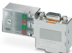
Conector D-SUB macho de 9 polos, salida de cables a 90°, sistema de bus: PROFIBUS DP hasta 12 Mbit/s con conector hembra D-SUB PG para la conexión de un equipo de programación, resistencia de cierre conectable mediante interruptor deslizante, esquema de polos: 3, 5, 6, 8; bornas de conexión por tornillo
