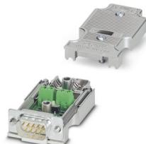
Conector D-SUB, 9 polos, macho, ejecución axial con dos entradas de cables, sistema de bus: PROFIBUS DP hasta 12 Mbits/s, resistencia terminal conectable a través de interruptor deslizante, ocupación de pins: 3, 5, 6, 8; bornes de conexión por tornillo
