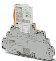
Protección contra sobretensiones que consta de protección enchufable y elemento de base, con indicación de estado integrada e interrupción por cuchilla para tres conductores de señales con potencial de referencia común. Para aplicaciones de alta frecuencia e interfaces de telecomunicación sin tensión de alimentación. Puesta a tierra indirecta mediante descargador de gas, homologación EX e para Zona 2. Puede utilizarse en circuitos orientados a la seguridad hasta SIL 3.
