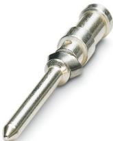
Contacto crimpado, diámetro de contacto: 1,6 mm, mecanizado, Macho, material contacto: Aleación de cobre, superficie de contacto: plateado, sección de conexión: 1,5 mm<sup>2</sup> ... 1,5 mm<sup>2</sup>, AWG 16
