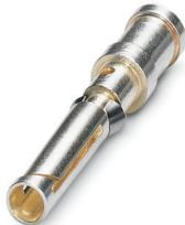
Contacto crimpado, diámetro de contacto: 1,6 mm, mecanizado, Hembra, material contacto: Aleación de cobre, superficie de contacto: plateado, sección de conexión: 1 mm<sup>2</sup> ... 1 mm<sup>2</sup>, AWG 18
