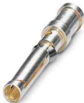
Contacto crimpado, diámetro de contacto: 1,6 mm, mecanizado, Hembra, material contacto: Aleación de cobre, superficie de contacto: plateado, sección de conexión: 1,5 mm<sup>2</sup> ... 1,5 mm<sup>2</sup>, AWG 16
