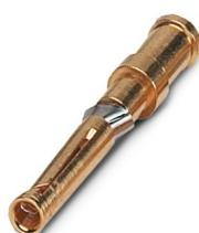
Contacto crimpado, diámetro de contacto: 1,6 mm, mecanizado, Hembra, material contacto: Aleación de cobre, superficie de contacto: dorado, sección de conexión: 0,75 mm<sup>2</sup> ... 0,75 mm<sup>2</sup>, AWG 18
