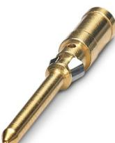
Contacto crimpado, diámetro de contacto: 1,6 mm, mecanizado, Macho, material contacto: Aleación de cobre, superficie de contacto: dorado, sección de conexión: 1,5 mm<sup>2</sup> ... 1,5 mm<sup>2</sup>, AWG 16
