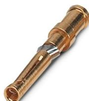
Contacto crimpado, diámetro de contacto: 1,6 mm, mecanizado, Hembra, material contacto: Aleación de cobre, superficie de contacto: dorado, sección de conexión: 0,14 mm<sup>2</sup> ... 0,37 mm<sup>2</sup>, AWG 26 ... 22
