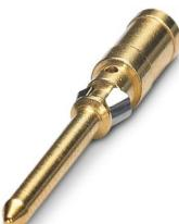
Contacto crimpado, diámetro de contacto: 1,6 mm, mecanizado, Macho, material contacto: Aleación de cobre, superficie de contacto: dorado, sección de conexión: 1 mm<sup>2</sup> ... 1 mm<sup>2</sup>, AWG 18
