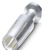
Contacto crimpado, diámetro de contacto: 4 mm, mecanizado, Hembra, material contacto: Aleación de cobre, superficie de contacto: plateado, sección de conexión: 2,5 mm<sup>2</sup> ... 2,5 mm<sup>2</sup>, AWG 14
