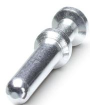
Contacto crimpado, diámetro de contacto: 4 mm, mecanizado, Macho, material contacto: Aleación de cobre, sin plomo, superficie de contacto: plateado, sección de conexión: 1,5 mm<sup>2</sup> ... 1,5 mm<sup>2</sup>, AWG 16
