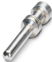
Contacto crimpado, diámetro de contacto: 2,5 mm, mecanizado, Macho, material contacto: Aleación de cobre, sin plomo, superficie de contacto: plateado, sección de conexión: 1,5 mm<sup>2</sup> ... 1,5 mm<sup>2</sup>, AWG 16
