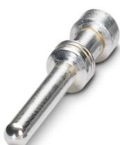
Contacto crimpado, diámetro de contacto: 2,5 mm, mecanizado, Macho, material contacto: Aleación de cobre, sin plomo, superficie de contacto: plateado, sección de conexión: 0,5 mm<sup>2</sup> ... 0,5 mm<sup>2</sup>, AWG 20
