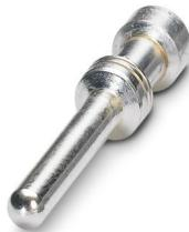
Contacto crimpado, diámetro de contacto: 2,5 mm, mecanizado, Macho, material contacto: Aleación de cobre, sin plomo, superficie de contacto: plateado, sección de conexión: 2,5 mm<sup>2</sup> ... 2,5 mm<sup>2</sup>, AWG 14
