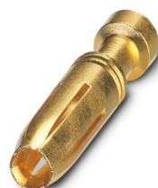
Contacto crimpado, diámetro de contacto: 2,5 mm, mecanizado, Hembra, material contacto: Aleación de cobre, sin plomo, superficie de contacto: dorado, sección de conexión: 1,5 mm<sup>2</sup> ... 1,5 mm<sup>2</sup>, AWG 16
