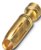
Contacto crimpado, diámetro de contacto: 2,5 mm, mecanizado, Hembra, material contacto: Aleación de cobre, sin plomo, superficie de contacto: dorado, sección de conexión: 1 mm<sup>2</sup> ... 1 mm<sup>2</sup>, AWG 18
