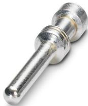
Contacto crimpado, diámetro de contacto: 2,5 mm, mecanizado, Macho, material contacto: Aleación de cobre, sin plomo, superficie de contacto: plateado, sección de conexión: 1 mm<sup>2</sup> ... 1 mm<sup>2</sup>, AWG 18
