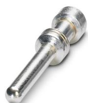
Contacto crimpado, diámetro de contacto: 2,5 mm, mecanizado, Macho, material contacto: Aleación de cobre, sin plomo, superficie de contacto: plateado, sección de conexión: 4 mm<sup>2</sup> ... 4 mm<sup>2</sup>, AWG 12
