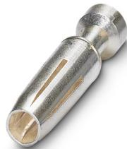
Contacto crimpado, diámetro de contacto: 2,5 mm, mecanizado, Hembra, material contacto: Aleación de cobre, sin plomo, superficie de contacto: plateado, sección de conexión: 1 mm<sup>2</sup> ... 1 mm<sup>2</sup>, AWG 18
