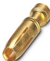
Contacto crimpado, diámetro de contacto: 2,5 mm, mecanizado, Hembra, material contacto: Aleación de cobre, sin plomo, superficie de contacto: dorado, sección de conexión: 2,5 mm<sup>2</sup> ... 2,5 mm<sup>2</sup>, AWG 14
