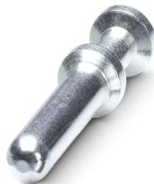
Contacto crimpado, diámetro de contacto: 4 mm, mecanizado, Macho, material contacto: Aleación de cobre, superficie de contacto: plateado, sección de conexión: 4 mm<sup>2</sup> ... 4 mm<sup>2</sup>, AWG 12
