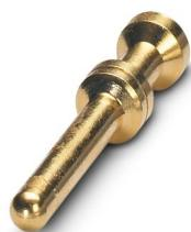
Contacto crimpado, diámetro de contacto: 2,5 mm, mecanizado, Macho, material contacto: Aleación de cobre, sin plomo, superficie de contacto: dorado, sección de conexión: 2,5 mm<sup>2</sup> ... 2,5 mm<sup>2</sup>, AWG 14
