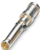
Contacto crimpado, diámetro de contacto: 1,6 mm, mecanizado, Hembra, material contacto: Aleación de cobre, sin plomo, superficie de contacto: plateado, sección de conexión: 0,75 mm<sup>2</sup> ... 0,75 mm<sup>2</sup>, AWG 18
