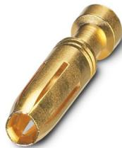
Contacto crimpado, diámetro de contacto: 2,5 mm, mecanizado, Hembra, material contacto: Aleación de cobre, sin plomo, superficie de contacto: dorado, sección de conexión: 0,5 mm<sup>2</sup> ... 0,5 mm<sup>2</sup>, AWG 20
