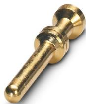
Contacto crimpado, diámetro de contacto: 2,5 mm, mecanizado, Macho, material contacto: Aleación de cobre, sin plomo, superficie de contacto: dorado, sección de conexión: 1,5 mm<sup>2</sup> ... 1,5 mm<sup>2</sup>, AWG 16
