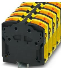
Borne de corriente, tensión nominal: 1000 V, corriente nominal: 309 A, número de conexiones: 2, número de polos: 1, tipo de conexión: Conexión PowerTurn, 1er piso, sección: 95 mm<sup>2</sup> - 185 mm<sup>2</sup>, clase de montaje: NS 35/15, color: negro/amarillo
