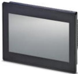
Panel táctil con 17,8 cm / 7"-TFT-pantalla (analógico-resistivo (poliéster)), 800 x 480 píxel(es) (WVGA), 262144 colores, Arm9™ i.MX28, 454 MHz, 2x COM (RS-232/422/485), 1x USB 2.0, Typ A, 1x USB 2.0, Typ B, 1x Ethernet (10/100 MBits/s), RJ45, Windows® CE 6.0 y software de usuario: Visu+. (sistema bus: sin)
