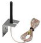
Antena omnidireccional, 2,4 GHz, ganancia: 2 dBi, polarización: lineal, ángulo de apertura: h/v 360°/75°, índice de protección: IP65, conexión: RSMA (macho), incl. cable de conexión de 1,5 m y soportes de montaje para montaje mural
