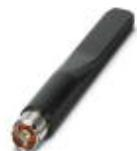
Antena omnidireccional, 2,4 GHz/5 GHz, ganancia: 2,5 dBi/5 dBi, polarización: lineal, ángulo de apertura: h/v 360°/30°/16°, índice de protección: IP68, conexión: N (macho), cable de conexión adecuado para pasamuros de armario de control (código 2701402)
