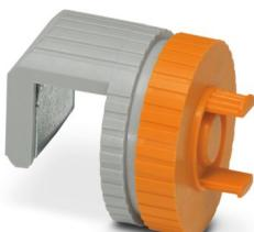
El dispositivo de sujeción opcional ofrece a la bobina Rogowski una fijación segura en barras colectoras con un grosor de 5 ... 10 mm. Durante la instalación, la caja de la bobina se desplaza a la brida del dispositivo de sujeción y se enclava automáticamente.
