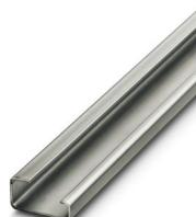
Carril simétrico sin perforar, Variante de embalaje con 10 unidades (20 m), según EN 60715, material: Acero, galvanizado, pasivado de capa gruesa, Perfil G, color: plateado
