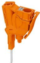
Borna de derivación, tensión nominal: 1000 V, corriente nominal: 32 A, número de conexiones: 2, tipo de conexión: Conexión push-in, 1er piso, Sección de dimensionamiento: 6 mm<sup>2</sup>, sección: 0,5 mm<sup>2</sup> - 10 mm<sup>2</sup>, clase de montaje: Montaje por encaje, color: naranja
