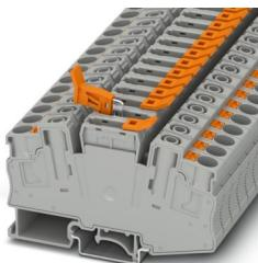
Borna interrumpible por cuchilla, tensión nominal: 1000 V, corriente nominal: 32 A, tipo de conexión: Conexión push-in, Sección de dimensionamiento: 6 mm<sup>2</sup>, sección: 0,5 mm<sup>2</sup> - 10 mm<sup>2</sup>, montaje: NS 35/7,5, NS 35/15, NS 32, color: gris
