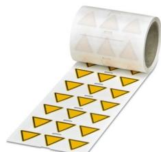
Placa de aviso, Rollo, amarillo/negro, sin rotular, rotulable con: THERMOMARK E.300 (D)/600 (D), THERMOMARK ROLL 2.0, THERMOMARK ROLL, THERMOMARK ROLL X1, THERMOMARK ROLLMASTER 300/600, THERMOMARK X1.2, clase de montaje: pegado, diámetro: 0 mm, Número de índices individuales: 500, altura del campo de texto: 25 mm, anchura del campo de texto: 25 mm
