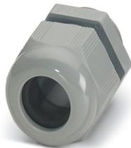
Prensaestopas, material conexión por tornillo: PA, aplicación: Estándar, diámetro exterior del cable 6 mm ... 12 mm, apantallamiento: no, rosca de conexión: M20 x 1,5, color: gris plata RAL 7001
