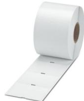
Etiqueta para superficies ásperas, Rollo, blanco, sin rotular, rotulable con: THERMOMARK E.300 (D)/600 (D), THERMOMARK ROLL 2.0, THERMOMARK ROLL, THERMOMARK ROLL X1, THERMOMARK ROLLMASTER 300/600, THERMOMARK X1.2, clase de montaje: pegado, Número de índices individuales: 1000, altura del campo de texto: 51 mm, anchura del campo de texto: 76 mm
