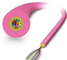
Canal universal GOF, 12 conductores, cable breakout mini para tendido fijo, protección contra roedores no metálica, fácil de colocar, resistente a los rayos ultravioleta, alta resistencia mecánica y térmica, humea poco, sin halógenos y autoextinguible, resistencia a las pisadas mejorada, resistente al agua longitudinal y transversalmente
