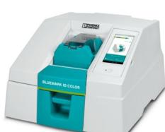
Impresora con impresión multicolor CMYK y tecnología de inyección de tinta UV, con software de rotulación integrado "MARKING system App", pantalla en color táctil de 7 pulgadas para imprimir rótulos de plástico en formato UC, UCT, US y UM, así como placas metálicas.
