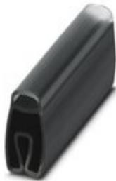
Soporte para señalización de conductores, transparente/negro, sin rotular, clase de montaje: deslizamiento, rango de diámetro de cable: 5 ... 10 mm, superficie útil: 30 x 4 mm
