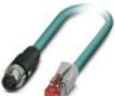
Cable de red, Ethernet CAT5 (100 MBit/s), 4-polos, PUR, azul agua RAL 5021, apantallado, Conector recta M12 SPEEDCON / IP67, codificación: D, a Conector recta RJ45 / IP20, longitud de cable: 1 m
