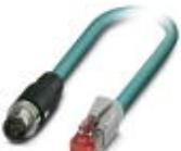
Cable de red, Ethernet CAT5 (100 MBit/s), 4-polos, PUR, azul agua RAL 5021, apantallado, Conector recta M12 SPEEDCON / IP67, codificación: D, a Conector recta RJ45 / IP20, longitud de cable: 5 m
