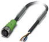
Cable para sensores/actuadores, 4-polos, PUR sin halógenos, negro grisáceo RAL 7021, extremo de cable libre, a Hembra de conexión recto M12, codificación: A, longitud de cable: 2 m
