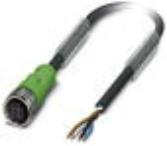
Cable para sensores/actuadores, 4-polos, PUR sin halógenos, negro grisáceo RAL 7021, extremo de cable libre, a Hembra de conexión recto M12, codificación: A, longitud de cable: 5 m
