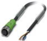
Cable para sensores/actuadores, 4-polos, PUR sin halógenos, negro grisáceo RAL 7021, extremo de cable libre, a Hembra de conexión recto M12, codificación: A, longitud de cable: 3 m
