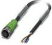
Cable para sensores/actuadores, 4-polos, PUR sin halógenos, negro grisáceo RAL 7021, extremo de cable libre, a Hembra de conexión recto M12, codificación: A, longitud de cable: 10 m
