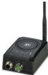
Módulo inalámbrico combinado Ethernet con Bluetooth y WLAN, antena omnidireccional sustituible, WLAN: AP y Client, 2,4 y 5 GHz, Bluetooth: 2.1+EDR/4.0, PAN hasta 7 conexiones, IP65, 9 ... 30 V DC, conexión M12, WEB, comandos AT y botón de modo
