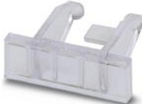
Marcador de regletas de bornes, para la señalización de regletas, encajable sobre los topes finales E/UK o CLIPFIX35, superficie útil: 25 x 6 mm
