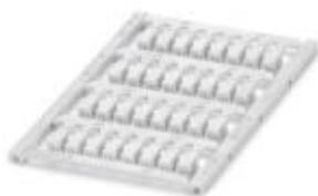
Marcado de conductores, Estera, blanco, sin rotular, rotulable con: TOPMARK NEO, TOPMARK LASER, BLUEMARK ID COLOR, BLUEMARK ID, BLUEMARK CLED, THERMOMARK PRIME, THERMOMARK CARD 2.0, THERMOMARK CARD, clase de montaje: enganchar, rango de diámetro de cable: 2 ... 2,9 mm, superficie útil: 12 x 4 mm, Número de índices individuales: 32
