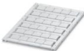
Marcador para bornes, Estera, blanco, sin rotular, rotulable con: TOPMARK NEO, TOPMARK LASER, BLUEMARK ID COLOR, BLUEMARK ID, BLUEMARK CLED, THERMOMARK PRIME, THERMOMARK CARD 2.0, THERMOMARK CARD, clase de montaje: encajar en ranura para índice alta, para ancho de borne: 12 mm, superficie útil: 10,8 x 9,6 mm, Número de índices individuales: 30
