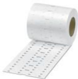
Marcador de cables, Rollo, blanco, sin rotular, rotulable con: THERMOMARK ROLLMASTER 300/600, THERMOMARK X1.2, THERMOMARK ROLL X1, THERMOMARK ROLL 2.0, THERMOMARK ROLL, clase de montaje: Montaje con sujetacables, diámetro de cable:  $\geq 6$  mm, superficie útil: 24 mm x 8 mm, Número de índices individuales: 4000
