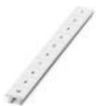
Tira Zack, Tiras, blanco, rotulado, rotulable con: CMS-P1-PLOTTER, Rotulación transversal: números correlativos de 1 ...10, 11 ...20 etc. hasta 91 ...100, clase de montaje: encajar en ranura para índice alta, para ancho de borne: 10,2 mm, superficie útil: 10,15 x 10,5 mm, Número de índices individuales: 10
