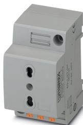
Toma de corriente, Cara enchufable tipo L, Conexión por resorte push-in, para Italia y otros países, con protección contra contactos accidentales ampliada/dispositivo de seguridad, gris, para el montaje sobre carril en la interfaz de servicio o montaje directo, 250 V AC, 16 A, -20 °C, 60 °C, CEI 23-50
