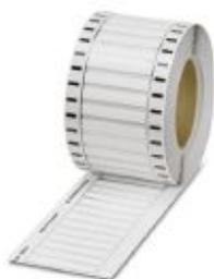
Entubado termorretráctil, Rollo, blanco, rotulable con: THERMOMARK ROLLMASTER 300/600, THERMOMARK X1.2, THERMOMARK ROLL X1, THERMOMARK ROLL 2.0, THERMOMARK ROLL: sin impresión, cortado, clase de montaje: deslizamiento, rango de diámetro de cable: 2,4 ... 4,8 mm, superficie útil: 30 x 9 mm, Número de índices individuales: 2000
