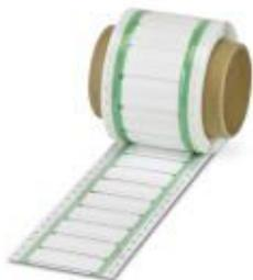
Entubado termorretráctil, Rollo, blanco, rotulable con: THERMOMARK ROLLMASTER 300/600, THERMOMARK X1.2, THERMOMARK ROLL X1, THERMOMARK ROLL 2.0, THERMOMARK ROLL: sin impresión, Perforado, clase de montaje: deslizamiento, rango de diámetro de cable: 4,2 ... 12,7 mm, superficie útil: 60 x 20 mm, Número de índices individuales: 250
