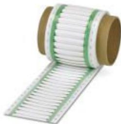
Entubado termorretráctil, Rollo, blanco, rotulable con: THERMOMARK ROLLMASTER 300/600, THERMOMARK X1.2, THERMOMARK ROLL X1, THERMOMARK ROLL 2.0, THERMOMARK ROLL: sin impresión, Perforado, clase de montaje: deslizamiento, rango de diámetro de cable: 1 ... 3,2 mm, superficie útil: 60 x 5 mm, Número de índices individuales: 250
