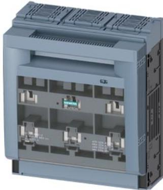
SENTRON, fusible-interruptor-seccionador 3NP1, 3 polos, NH3, 630 A, para Montaje e instalación en placa de montaje, borne de caja, Plano de cubierta 70 mm
