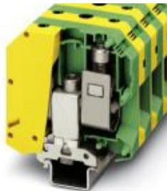
Borne de tierra para carril, tipo de conexión: Conexión por tornillo, número de conexiones: 2, número de polos: 1, sección: 25 mm<sup>2</sup> - 95 mm<sup>2</sup>, AWG: 4 - 3/0, anchura: 25 mm, color: amarillo-verde, clase de montaje: NS 35/7,5, NS 35/15, NS 32
