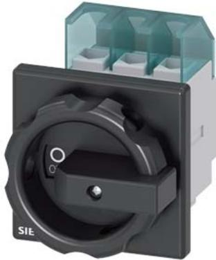
SENTRON, interruptor-seccionador 3LD, interruptor principal, 3 polos, Iu: 25 A, Potencia de empleo / con AC-23 A a 400 V: 9,5 kW, con fijación frontal, Accionamiento giratorio, negro, Fijación por 4 taladros de la maneta
