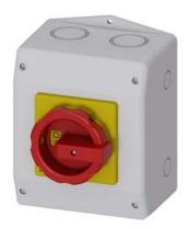
SENTRON, interruptor-seccionador 3LD, Pulsador de parada de emergencia, 3 polos, lu: 63 A, Potencia de empleo / con AC-23 A a 400 V: 22 kW, Envolvente de material aislante para medida métrica de pasacables, 1NC, 1NA, Accionamiento giratorio, rojo/amarillo
