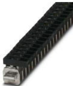
Borne de conexión, tipo de conexión: Conexión por tornillo, corriente de carga: 41 A, sección: 0,5 mm<sup>2</sup> - 6 mm<sup>2</sup>, anchura: 7 mm, color: negro
