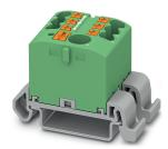
Bloque para distribución, Bloque con alineación horizontal y alimentación integrada, Los bloques se pueden puentear entre sí mediante el canal de conductores. Puentes enchufables adaptados, véanse accesorios, tensión nominal: 690 V, corriente nominal: 24 A, tipo de conexión: Conexión push-in, Conexión push-in, número de conexiones: 7, sección: 0,14 mm² - 4 mm², AWG: 26 - 12, anchura: 25,6 mm, color: verde, clase de montaje: NS 35/7,5, NS 35/15
