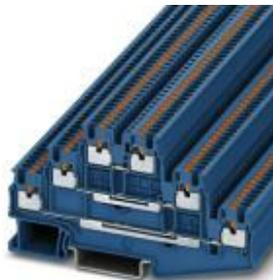
Borne multipiso, tipo de conexión: Conexión push-in, sección: 0,14 mm<sup>2</sup> - 1,5 mm<sup>2</sup>, AWG: 26 - 14, anchura: 3,5 mm, color: azul, clase de montaje: NS 35/7,5, NS 35/15
