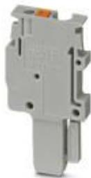
Conector, tensión nominal: 500 V, corriente nominal: 17,5 A, tipo de conexión: Conexión push-in, número de conexiones: 1, número de polos: 1, sección: 0,14 mm<sup>2</sup> - 1,5 mm<sup>2</sup>, AWG: 26 - 14, anchura: 3,5 mm, altura: 31,3 mm, color: gris
