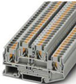
Borne de doble piso, tipo de conexión: Conexión push-in, sección: 0,2 mm<sup>2</sup> - 6 mm<sup>2</sup>, AWG: 24 - 10, anchura: 6,2 mm, color: gris, clase de montaje: NS 35/7,5, NS 35/15
