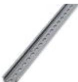
Carril simétrico perforado, Perfil estándar, anchura: 35 mm, altura: 7,5 mm, según EN 60715, material: Acero, Galvanizado, pasivado blanco, longitud: 2000 mm, color: plateado
