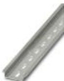
Carril simétrico perforado, Perfil estándar, anchura: 35 mm, altura: 7,5 mm, según EN 60715, material: Acero, galvanizado, pasivado de capa gruesa, longitud: 2000 mm, color: plata
