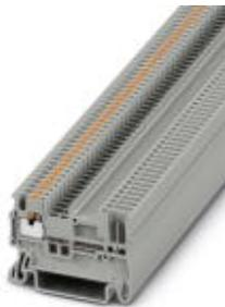
Borne de paso, tensión nominal: 500 V, corriente nominal: 17,5 A, tipo de conexión: Conexión push-in / conexión enchufable, número de conexiones: 2, sección: 0,14 mm<sup>2</sup> - 1,5 mm<sup>2</sup>, AWG: 26 - 14, anchura: 3,5 mm, altura: 30,5 mm, color: gris, clase de montaje: NS 35/7,5, NS 35/15
